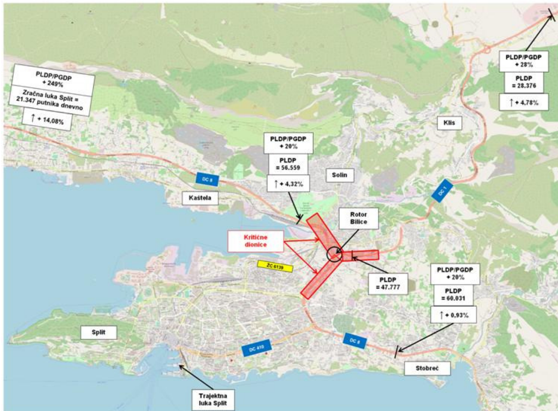
Slika 10-2. Nedostaci postojeće cestovne mreže na ulazu u Split
